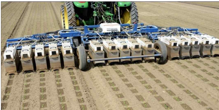
<그림 5> 블루리버테크놀리지의 선택제초 씨앤스프레이 시스템(see & spray)
